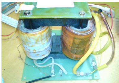
Obr. 8.14: Testovaný VN transformátor (Lifetech)
