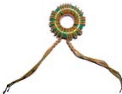
Obr. 8.20: Neimpregnovaný transformátor typ A
