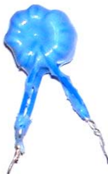
Obr. 8.25: Impregnovaný transformátor z TAV 0,20 SM, typ B
