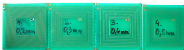
Obr. 8.32: Experimentální vzorky jednostranných planárních transformátorů s nepájivou maskou
