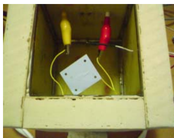
Obr. 8.68: Měření vzorku z nízkoteplotní keramiky Heraclon HL2000 v teplotní komoře
