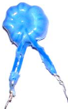
Obr. 8.25: Impregnovaný transformátor z TAV 0,20 SM, typ B
