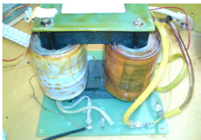
Obr. 8.14: Testovaný VN transformátor (Lifetech)
