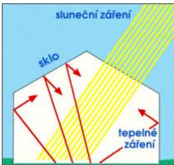
Obrázek 9 - fungování skleníku (zdroj: [29])
