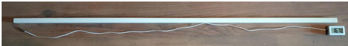
Obrázek 23 – čidlo na měření v hloubce 0,9m (zdroj: vlastní zpracování)
