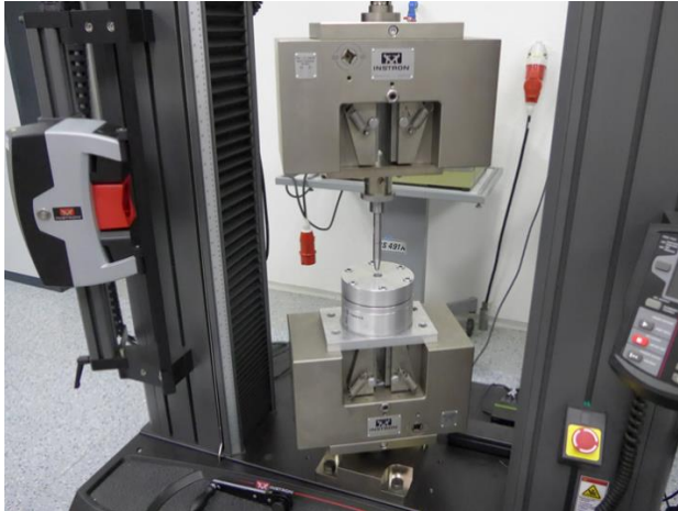
Obr. 7.3 aparatura pro zkoušku protlačení trnem
