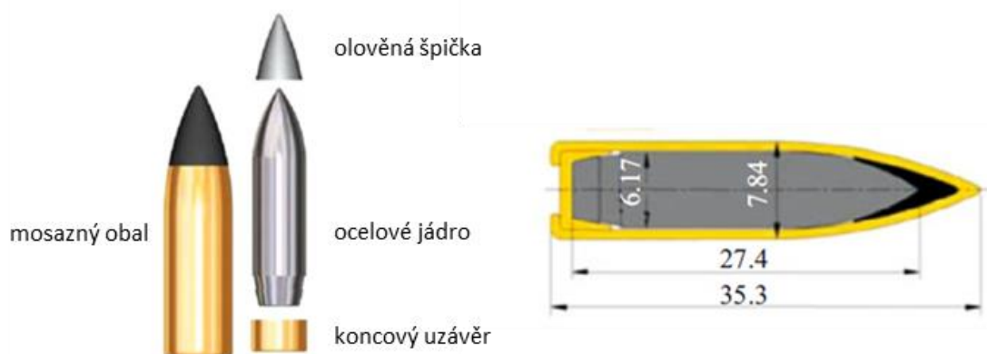
Obr. 4.9 Struktura 0.3" APM2 projektilu [17]
