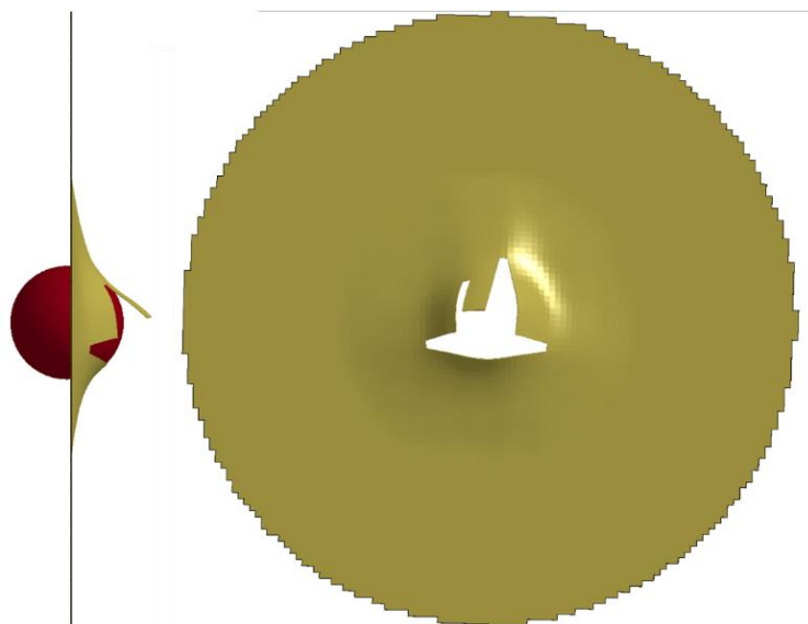
Obr. 8.38 Model tkaniny po protržení
