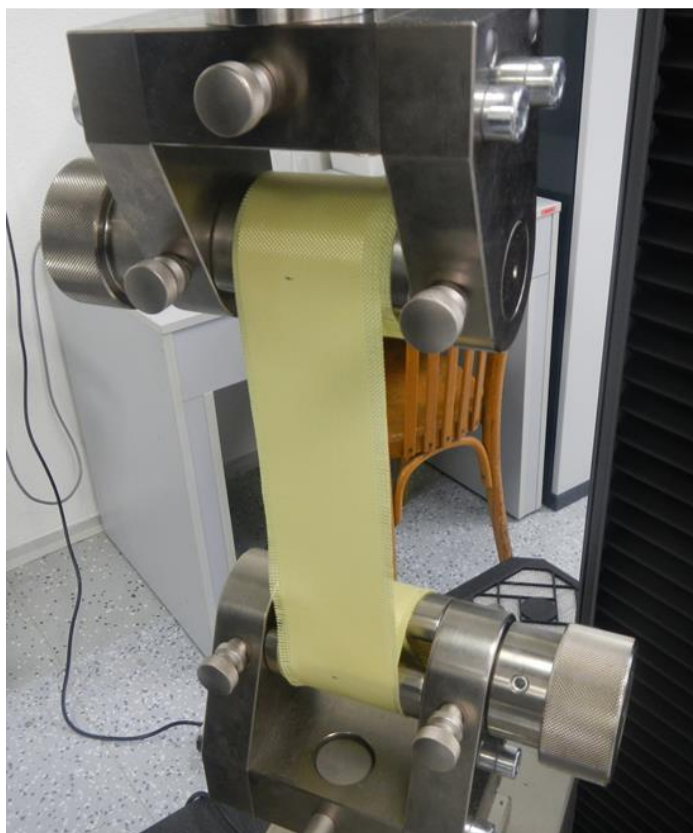
Obr. 7.1 Tahová zkouška tkaniny, nezátěžený stav (vlevo), tkanina na konci zkoušky (vpravo)
