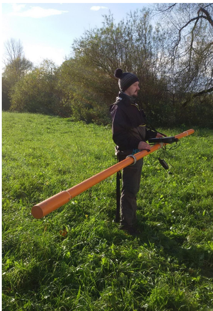
Obr. 9: Elektromagnetický měřič vodivosti CMD-4 s připojenou GPS
