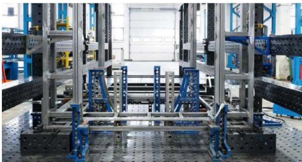
Obrázek 1.12: Stavebnicový přípravek se systémem Otvor – čep (Jcmetal.cz, 2019)
