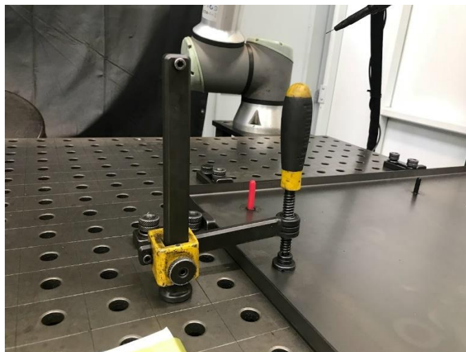
Obrázek 1.14: Příklad možnosti upnutí a polohování pomocí svěrek a dorazů
