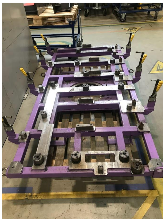
Obrázek 1.19: Ukázka rámu přípravku pro předem nabodované svařence pro robotizované svařovací pracoviště Valk Welding
