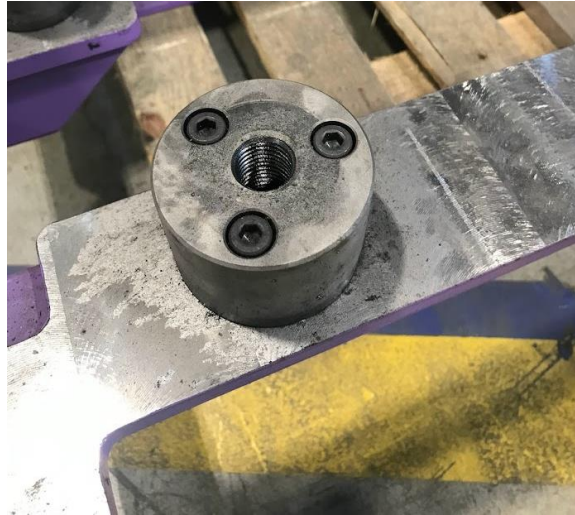
Obrázek 1.22 – Podpěrný váleček s dírou pro šroub se závitem
