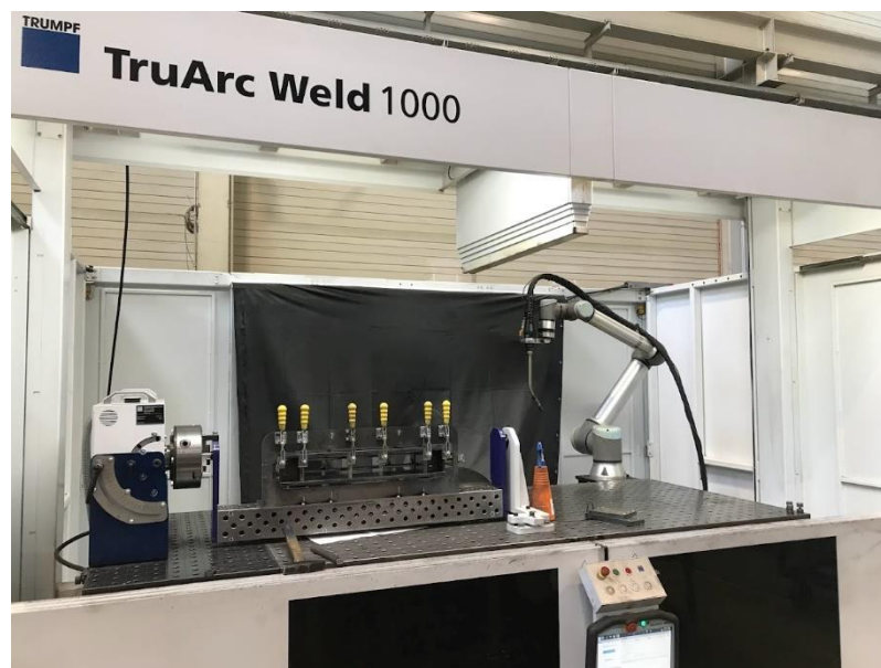
Obrázek 1.5: Kolaborativní robot Trumf TruArc Weld 1000
