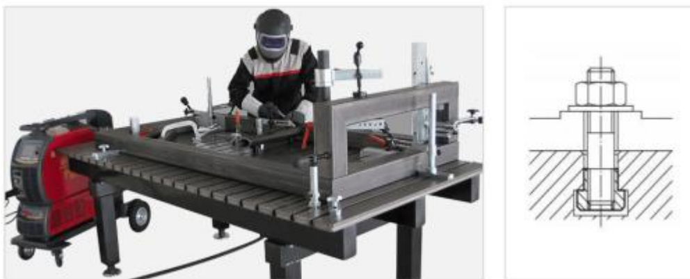
Obrázek 1.11: Stavebnicový přípravek se stolem s T drážkami (Jcmetal.cz, 2019)
