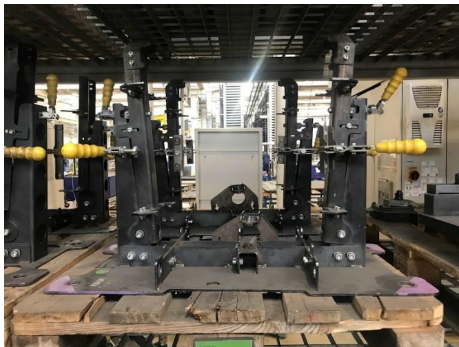
Obrázek 1.20: Přípravek pro nenabodované svařence menších rozměrů
