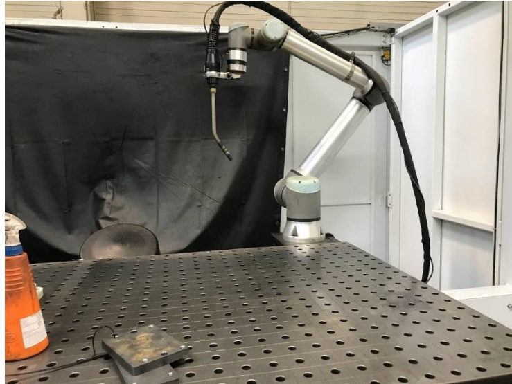
Obrázek 1.13: Děrovaný upínací stůl cobota od společnosti Trumpf
