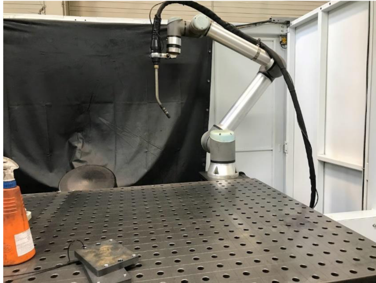
Obrázek 1.13: Děrovaný upínací stůl cobota od společnosti Trumpf
