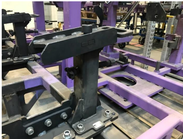
Obrázek 1.24 – Svislá upínka s horní posuvnou částí na vyvýšené vertikální stojně
