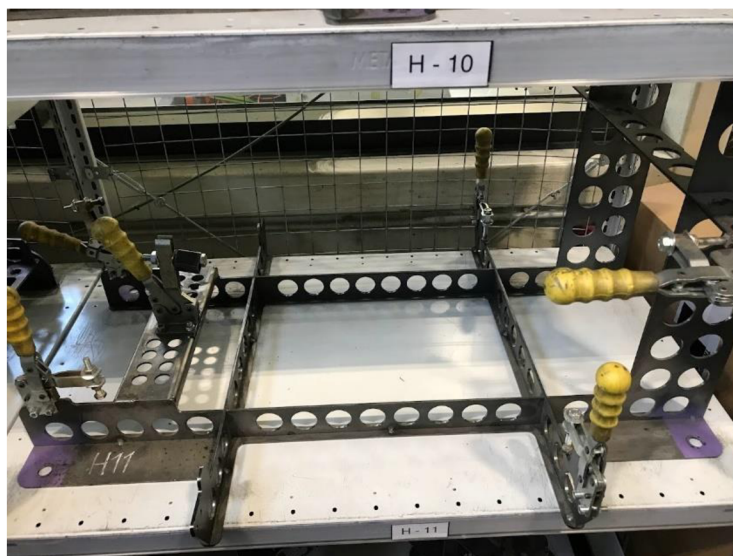
Obrázek 1.16: Jednúčelový přípravek pro pracoviště s cobotem společnosti Trumpf
