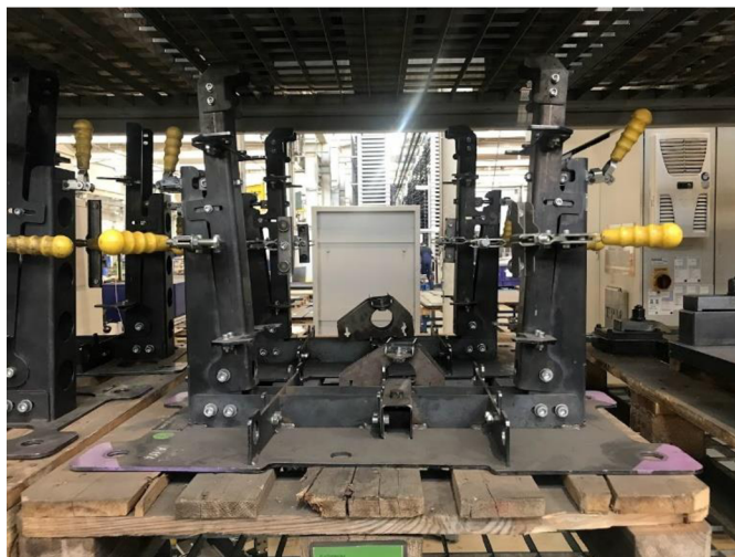
Obrázek 1.20: Přípravek pro nenabodované svařence menších rozměrů
