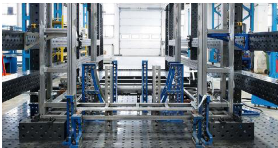
Obrázek 1.12: Stavebnicový přípravek se systémem Otvor – čep (Jcmetal.cz, 2019)
