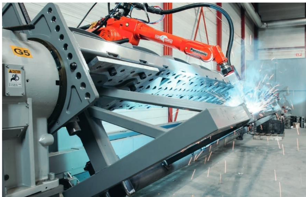
Obrázek 1.2: Příklad robotického svařovacího pracoviště od společnosti Valk Welding (Val-kwelding.com, 2021)
