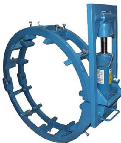
Obrázek 1.35: Hydraulická kruhová upínka pro švové svařování trubek (Dwt-pipetools.com, 2023)
