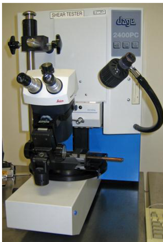
Obrázek 26: Zařízení Dage PC 2400 které umožňuje nejen test stříhem ale také tzv. Tweezer pull test a Wire pull test.
