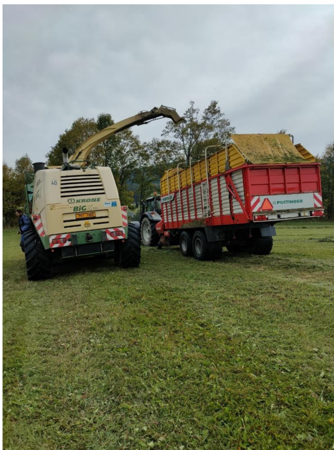
Obrázek 1.7 - Sklizení píce pomocí samochodné řezačky Krone
