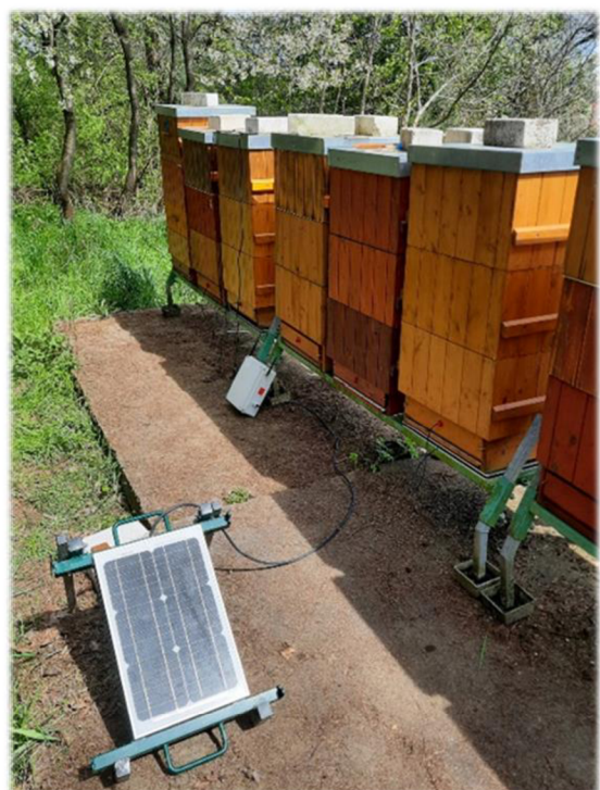
Nainstalovaná GSM brána včetně solárního p.
