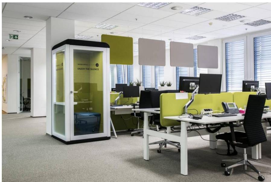
Obrázek 18 Akustická tělesa v kanceláři [27]
