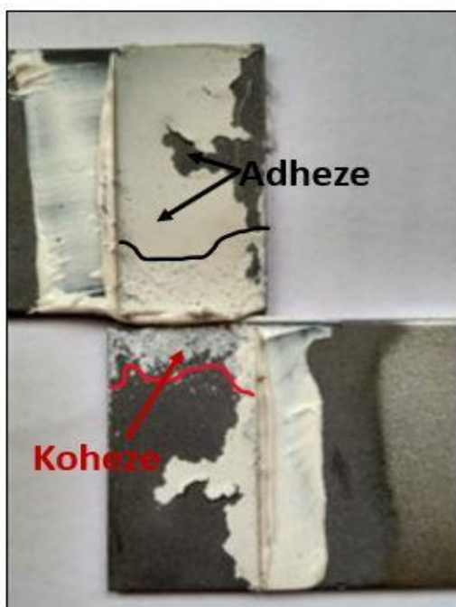
Obrázek 29 Lomová plocha lepeného spoje s otryskaným a odmaštěným povrchem
