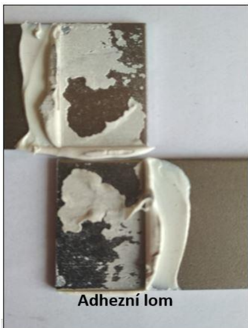
Obrázek 31 Lomová plocha lepeného spoje s odmaštěným povrchem Zdroj: [vlastní zpracování]
