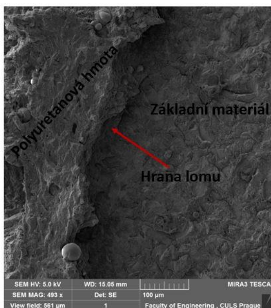
Obrázek 34 Lepený spoj s otryskaným povrchem (MAG 493 x) Zdroj: [vlastní zpracování]
