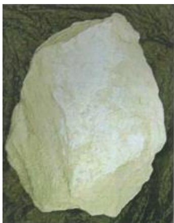
Obr. 3 Vzorek křemeliny v pevném stavu (24)
