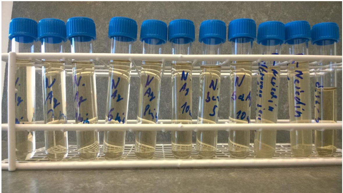
Obr. 35 - Výsledky tvorby zákalu (bakteriální růst) po kultivaci třepané vody z jezírka s kompozitem (1. – 6. zkumavka zleva) a čistou křemelinou (7. a 8. zkumavka zleva)
