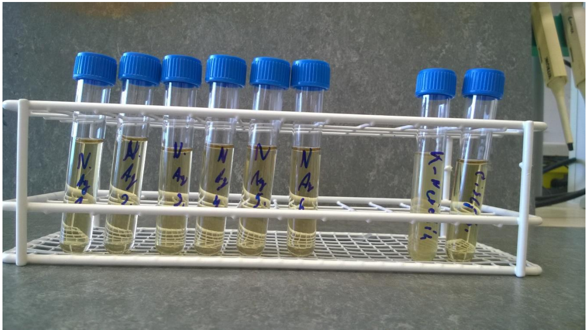
Obr. 20 - výsledky tvorby zákalu (bakteriální růst) po kultivaci vody z jezírka filtrované přes kompozit Diacelit/nanoAg, kontrolní vzorky
