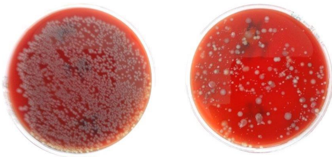
Obr. 37 - Nárůst kolonií tvořících jednotku na agaru po 24 hodinové kultivaci při 36°C bakteriální suspenze E. coli (vlevo) a vody z jezírka (vpravo)
