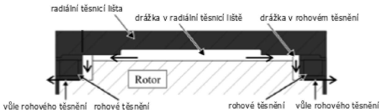
Obrázek 24 Profuk plynů rohovým těsněním [17]
