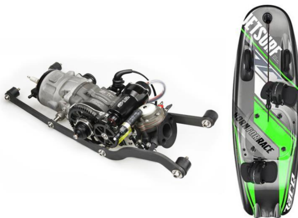
Obrázek 50 Současný dvoudobý motor Jetsurfu [23],[24]
