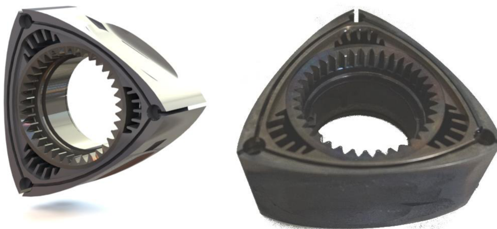
Obrázek 27 Render a vyrobený díl rotoru zadaného motoru
