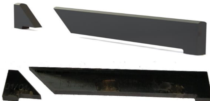
Obrázek 28 Render a vyrobené díly radiální těsnicí lišty
