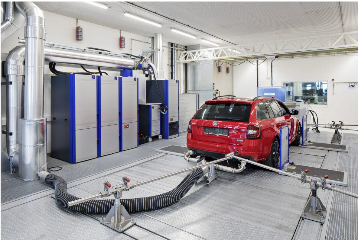
Obrázek 7 Testování ve zkušebně vybavené válcovým dynamometrem [25]
