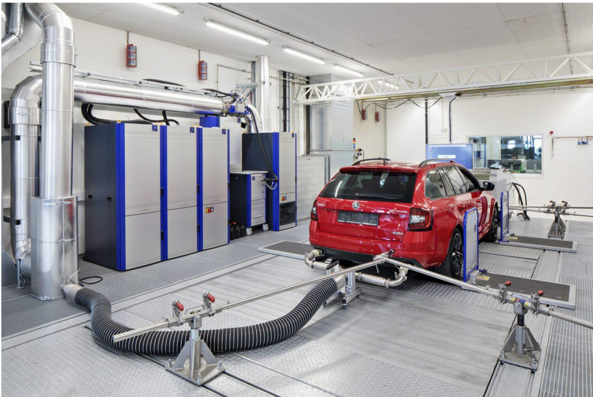
Obrázek 7 Testování ve zkušebně vybavené válcovým dynamometrem [25]
