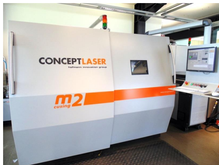
Obrázek 1: Tiskárna Concept laser M2 Cusing pro 3D tisk z kovu [9].
