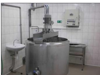
Tous les deux jours, le 100 litres de lait est mené par les tuyaux du réservoir collecteur vers la salle de production dans le pasteur où le lait est pasteurisé. Le pasteur est également une bassine de fabrication dans lequel le lait pasteurisé est ensuite fermenté et coagulé. Puis les moules sont remplis par la pâte et sont mis sur la table d'égouttage.
