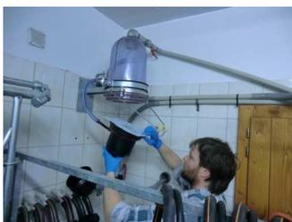
La préparation de la salle de traite signifie la préparation des équipements de la salle. Il faut d'abord dégorger le réseau des tuyaux par lequel le lait est mené. Ensuite il faut préparer le filtre dans la chambre de réception pour que les malpropretés ne restent pas dans le lait et ne provoquent pas de processus microbien.
