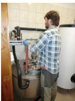
Le lait est mené par les tuyaux et l'échangeur à plaques, qui le refroidit, jusqu'au réservoir collecteur. Ici le lait est stocké et rafraîchi jusqu'à la production.
