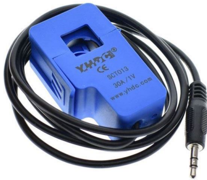
Obr. 2.7: Prúdová sonda a jej špecifikácia [28].
