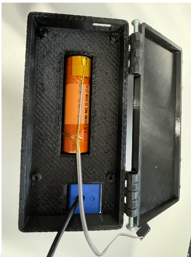
Obr. B.1: Osadenie akumulátora do zariadenia
