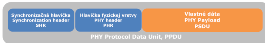
OBR. 12 ŠTRUKTÚRA PAKETU NA FYZICKEJ VRSTVE
