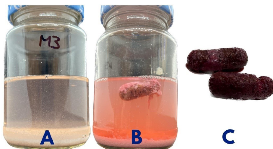
Obrázek 26: Vzorky po ukončení 1,5hodinového modelového gastrointestinálního trávení (A – výsledek trávení želatinového bonbonu s trnkovým extraktem (M15); B – výsledek trávení želatinové kapsle s lyofilizovaným práškem z plodů PsL; C – nestrávený zbytek náplně želatinové kapsle).
