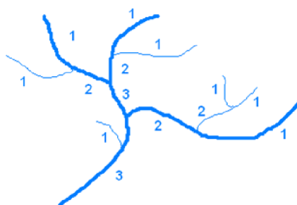
Obrázek 16 - znázornění principu relativní řádovosti dle Stahlera (Hydro.upol.cz, [15.2.2022])
