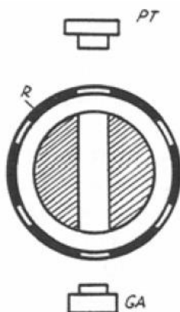
Obr. č. 4.15 Optoelektronický snímač otáček – překreslit [14]
