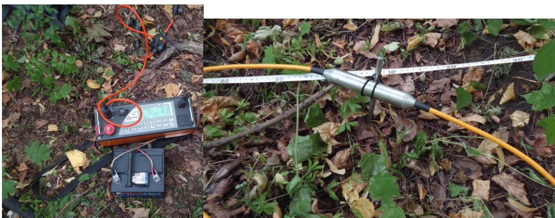
Přístroj ARES je složen z nerezových elektrod (trnů), řídicí jednotky, externí baterie, multielektrodových kabelů (12 kusů) a T-kusu, který propojuje řídicí jednotku a multielektrodový kabel.
