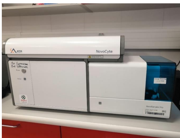
Obrázek 6: Průtokový cytometr - Novocyte 3000, Acea Biosciences (archiv autora).
