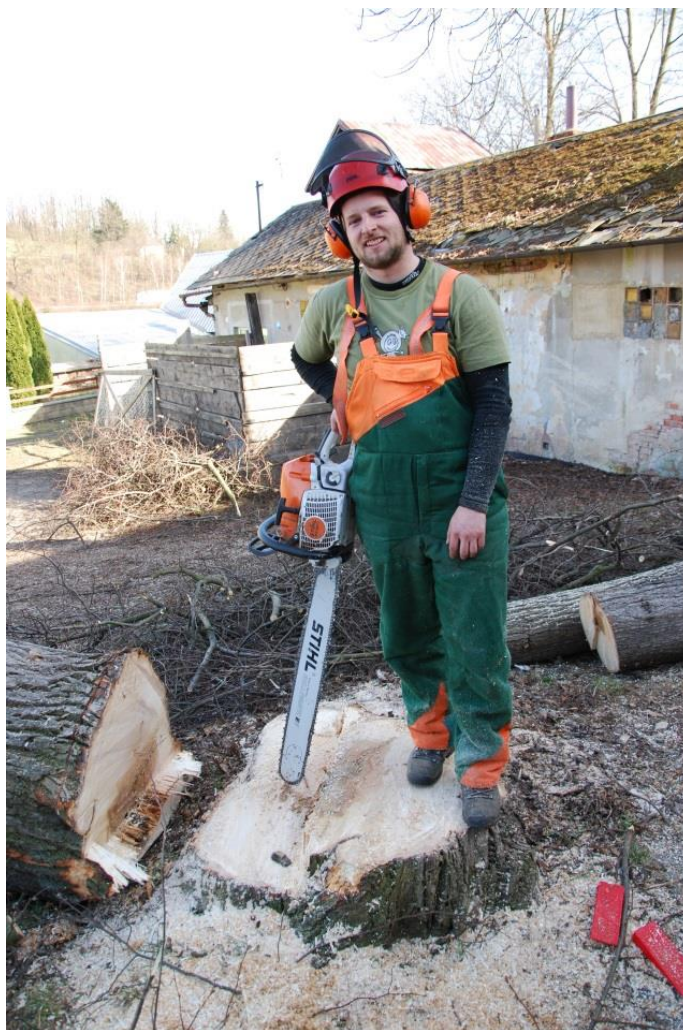
Obr. 11: arborista vybavený helmou s plexisklem a sluchátky, důležitá je i pevná obuv, neprořezné kalhoty a rukavice
