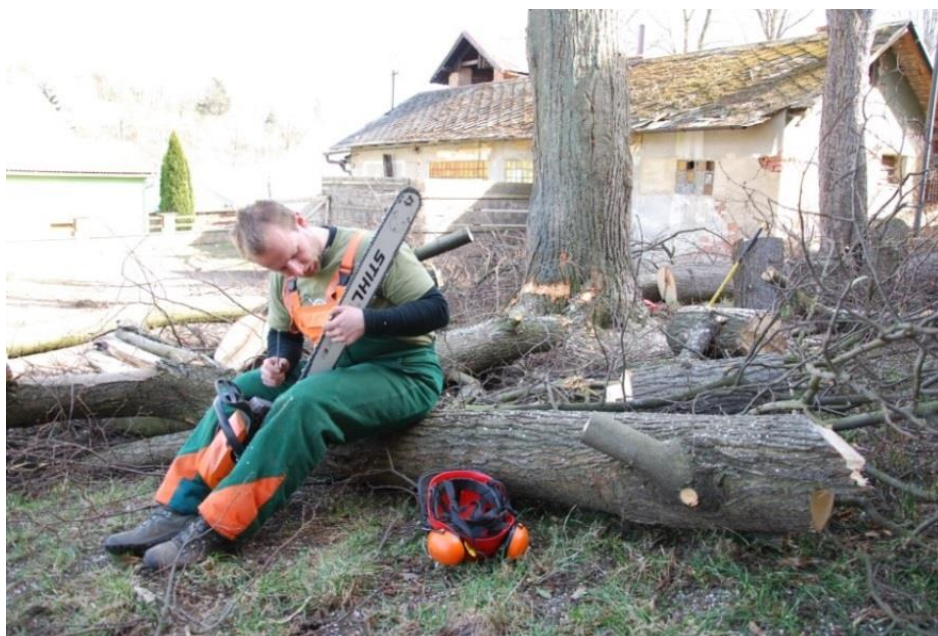
Obr. 16: broušení řetězu pily pilníkem se provádí podle potřeby před nebo i po kácení
