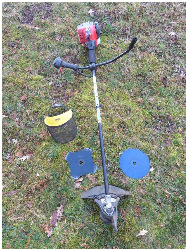
Obr. 10: křovinořez se dvěma typy pilových kotoučů a s ochranným štítem na obličej
