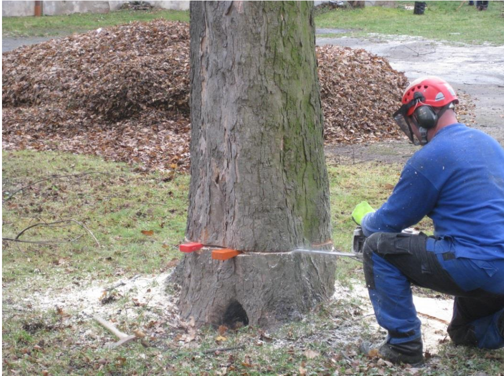
Obr. 29: použití klínů z plastických hmot proti sevření pily v řezu
