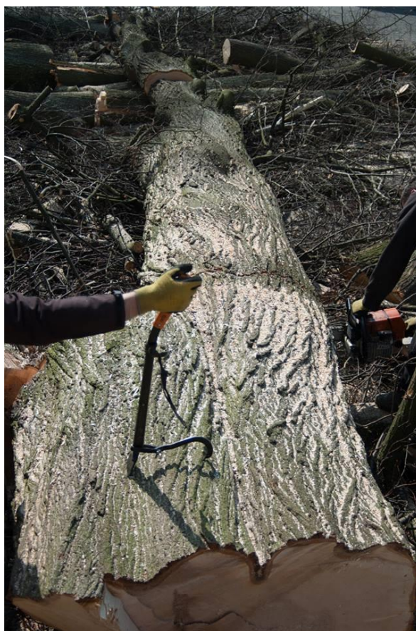
Obr. 61: dřevorubecká lopatka v kombinaci s hákem lze použít jako obracák a slouží k manipulaci se dřevem, k otáčení nebo popotahování částí kmenů, v řezu pomáhá k naklonění stromu menších průměrů nebo při rozřezávání kmenů zabraňuje sevření pily v řezu
