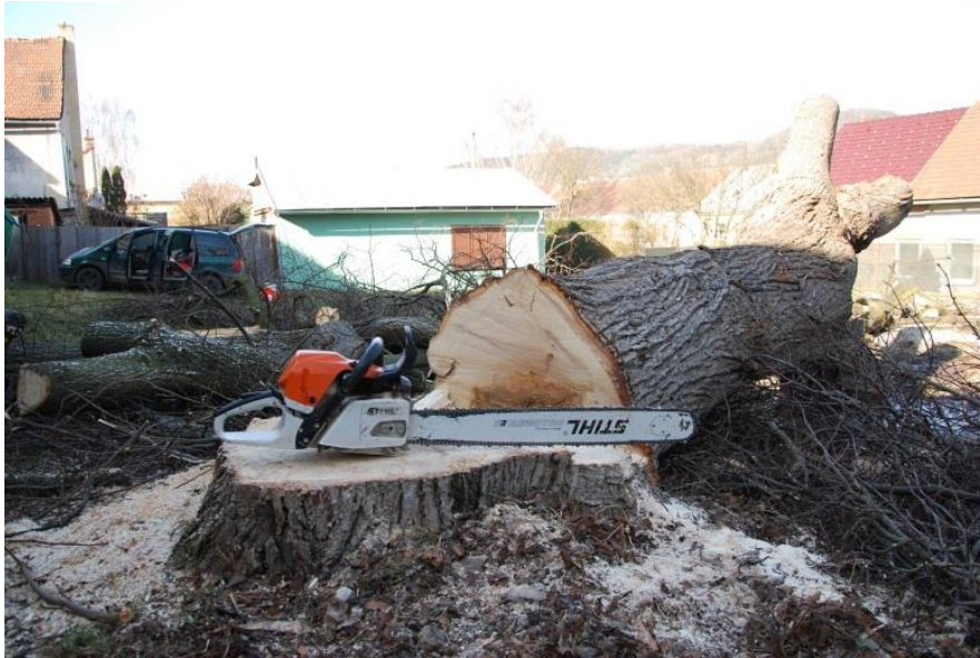
Obr. 9: pily, které mají vodící lištu velkých rozměrů, jsou nezbytné při kácení stromů s nadměrným průměrem kmene
