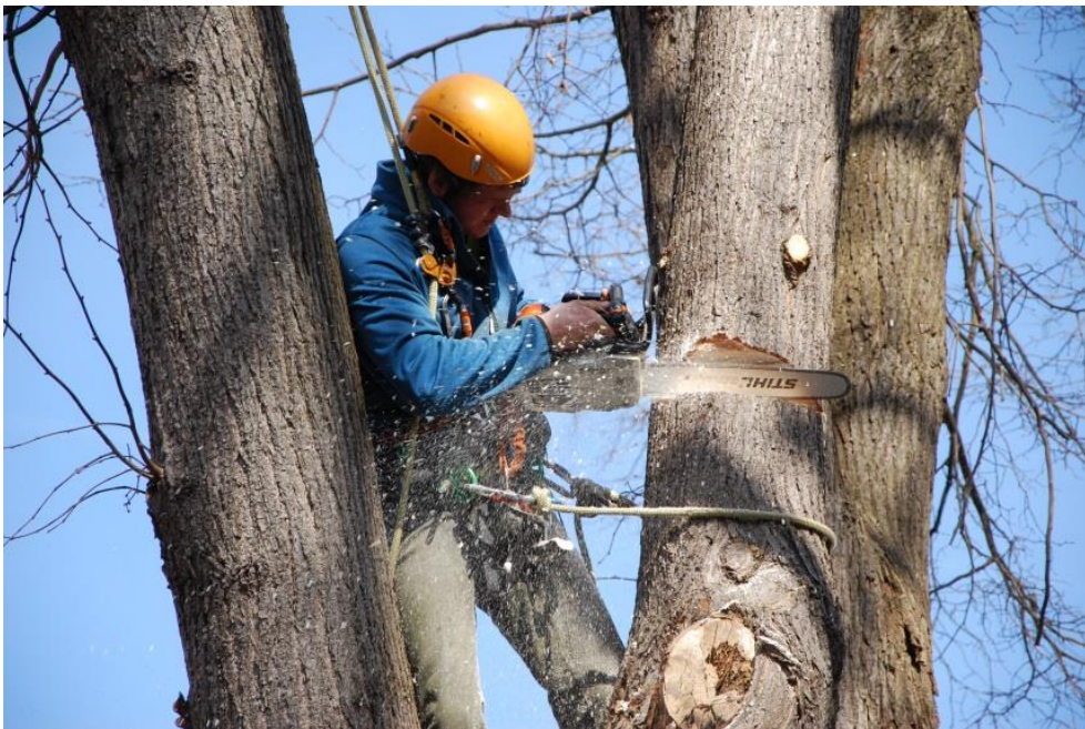
Obr. 26: směrový zásek je při postupném kácení v koruně stromu vytvářen stejně, jako při volném kácení u země
