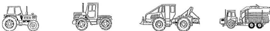
Obr. 19: univerzální traktor, speciální traktor, speciální lesní kolový tahač (skider) a vyvážecí traktor (forwarder), (Neruda, Nevrkla, Ladra, 2014)
