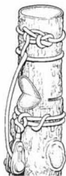
Obr. 37: metoda špalkování do lana u kmene (Donzelli, 2006)
