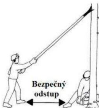
Obr. 6: práce s přetlačnou tyčí (Neruda, Nevrkla, Ladra, 2014)
