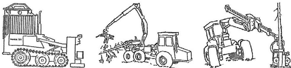
Obr. 18: kompaktní, dvoufázový a jednofázový harvestor (Bílek a kol., 2013)
