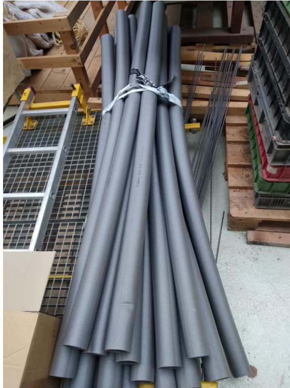
Obrázek 30: Izolační trubka z PVC použita k obvodové konstrukci a tvorbě přepážek [33]
