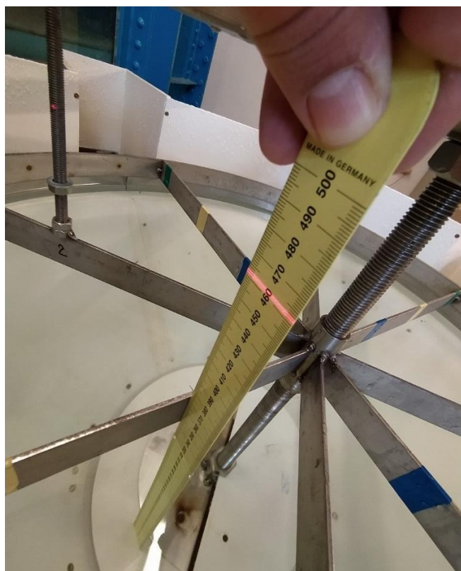
Obr. 22 Měření parametru 4 – výškové umístění tlumícího prvku pomocí ocelové měřky
