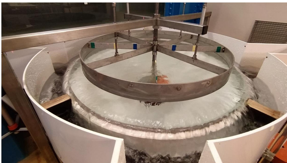
Obr. 40 Proudové poměry na modelu RO při 3,00 \text{ m}^3/\text{s}
