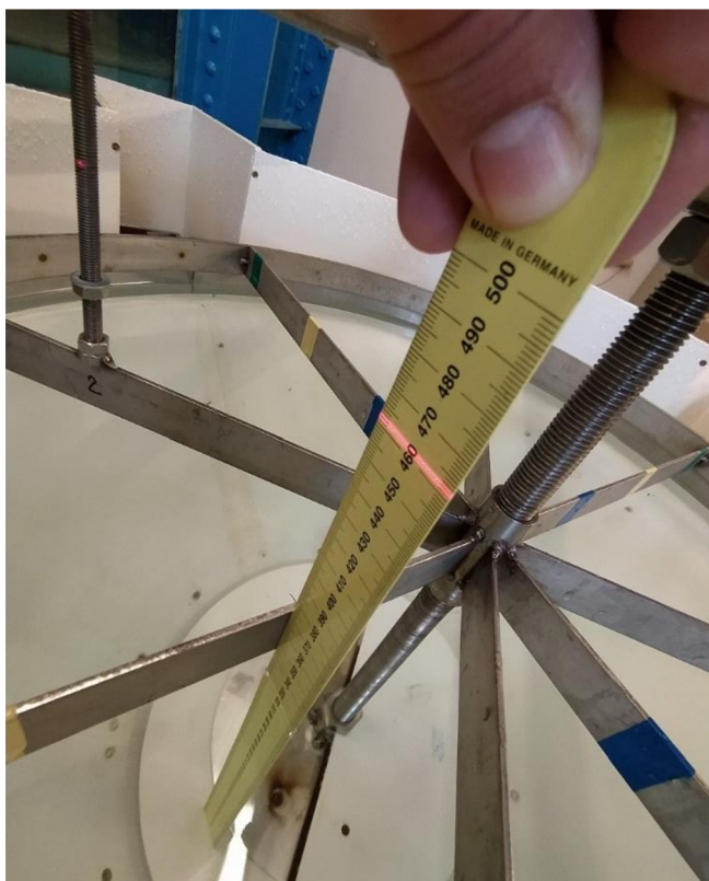
Obr. 22 Měření parametru 4 – výškové umístění tlumícího prvku pomocí ocelové měrky
