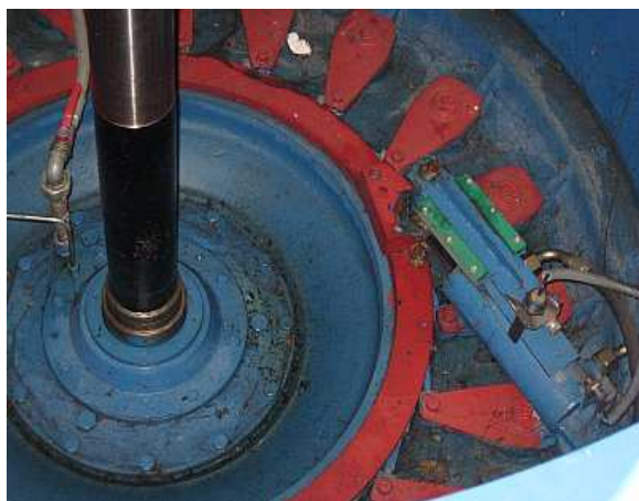
Obr.14 Regulační prstenec ovládající rozváděcí lopatky pomocí hydraulického pohonu
