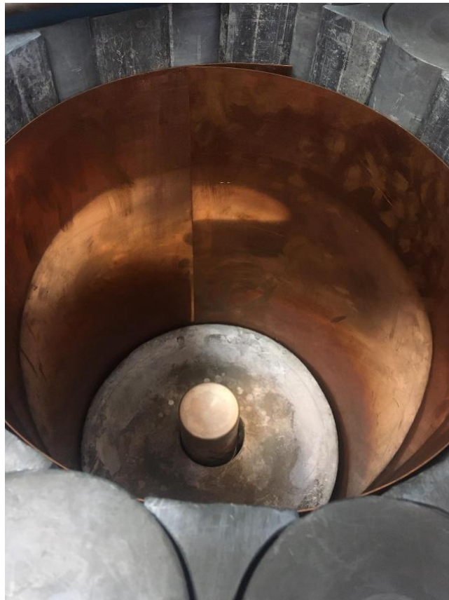
Obrázek 28: Kobka s polovodičovým detektorem
