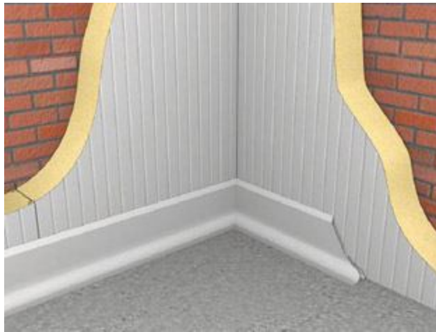
Obr. 5 Vnitřní izolační systém mrazírny (26)
