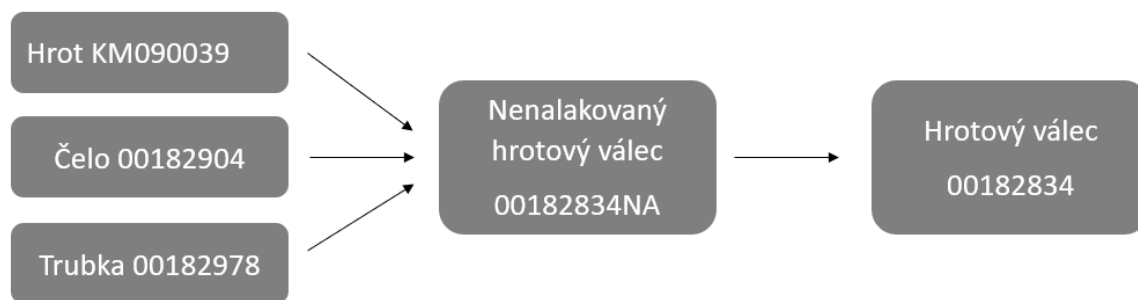
Obr. 12 Polotovary pro výrobu hrotových válců
