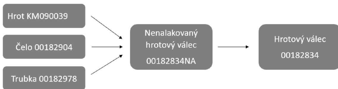
Obr. 12 Polotovary pro výrobu hrotových válců
