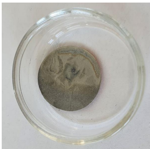
Obrázek 4.5 Vyseknutá elektroda po depozici olova střídou 1:1.
