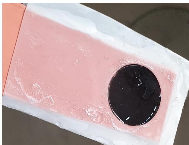
Obrázek 4.19 Kobaltová elektroda po 30 min depozici
