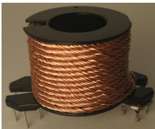
Obr. 3.1: Navinutá tlumivka L3 bez feritového jádra.
