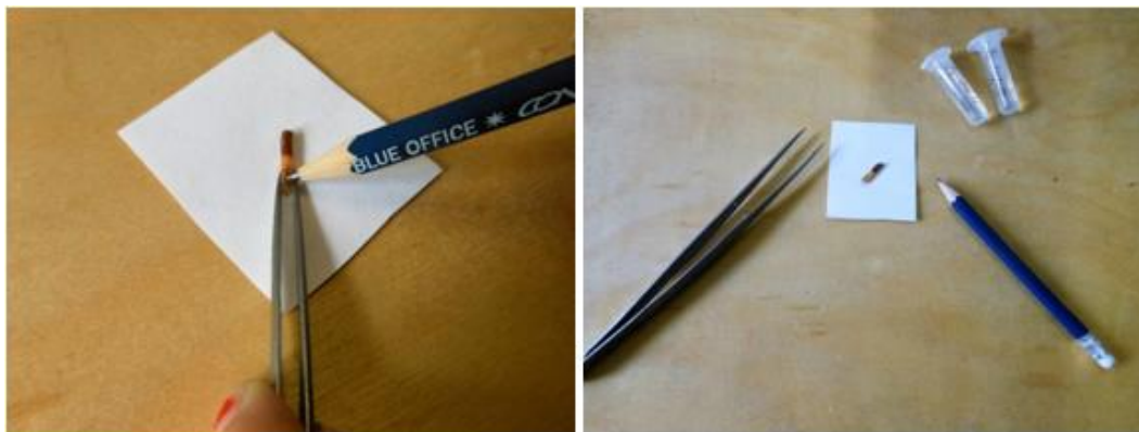
Obr. 3: Označení příčného řezu na mikrovývrty
