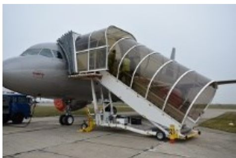
Schody tažené CDS 2438 zastřešené
