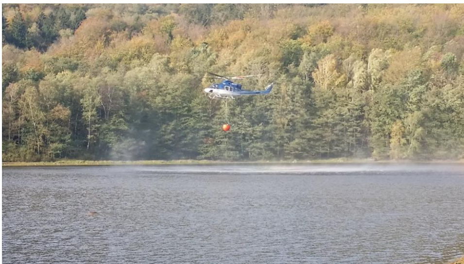
Obr. 2 Plnění vaku nořením. Požár lesa v katastru obce Raspenava dne 15. 10. 2018 (foto Vaněk)
