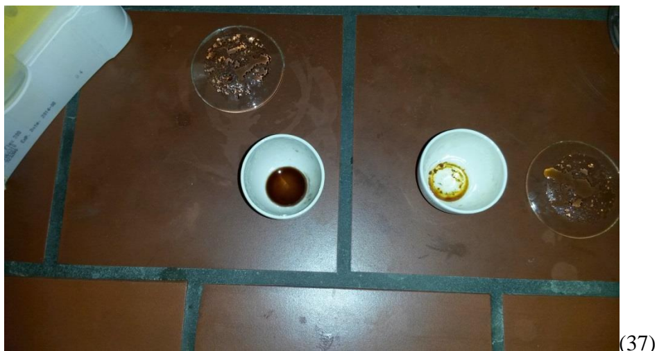
Obr. č. 37 – Kyselina mravenčí (vlevo) a kyselina octová (vpravo) ve směsi s anilinem po ukončení zahřívání.
