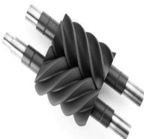
Obrázek 3.1-3 Šroubové dmyhadlo s konstrukcí plug-and-run. [10]
