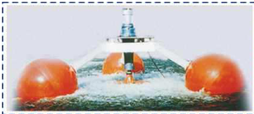
Obrázek 3.5-13 Provdzušňovací turbína BSK [17]
