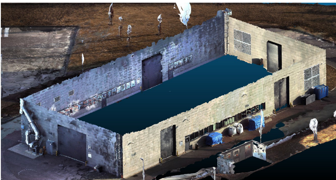
Obrázek 21 - 2D vizualizace části mesh modelu – hala
