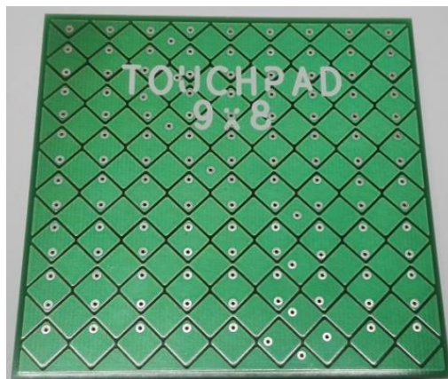
Obrázek 24 Uspořádání elektrod modulu touchpadu
