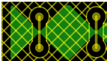
Obrázek 12 Řešení zemní plochy pod elektrodami
