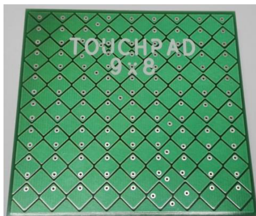
Obrázek 24 Uspořádání elektrod modulu touchpadu
