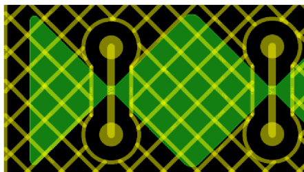
Obrázek 12 Řešení zemní plochy pod elektrodami
