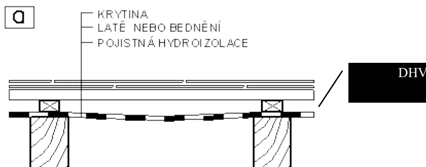
Obrázek 10 Konstrukční řešení střešního pláště bez tepelné izolace [22]
