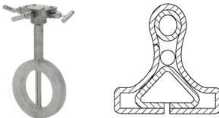
Obrázek 5: Vlevo - rychlostní sonda [20], vpravo - průřez sondou Annubar [21].
